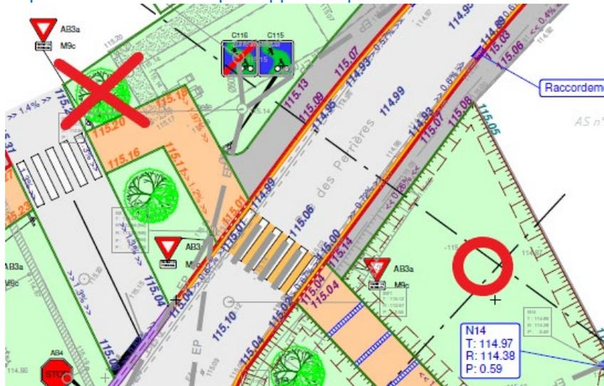
La géométrie de la voie verte dans l'ancienne aire de jeux est légèrement modifiée pour préserver un arbre. De plus, le raccordement sur la rue de la Croix Collinet est légèrement déplacé pour éviter un regard de comptage AEP :
